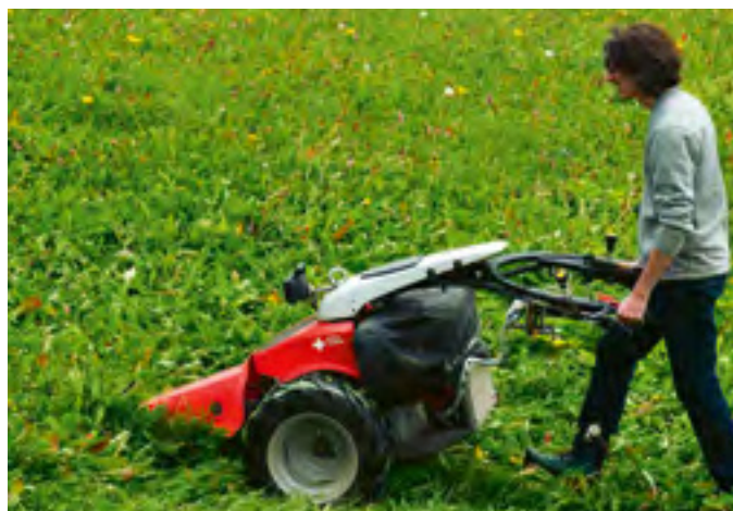
Knackpunkt ist derzeit noch das Gewicht der hier noch abgedeckten Batterie.
